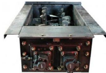
Смеситель с двумя приводами и двумя валами
